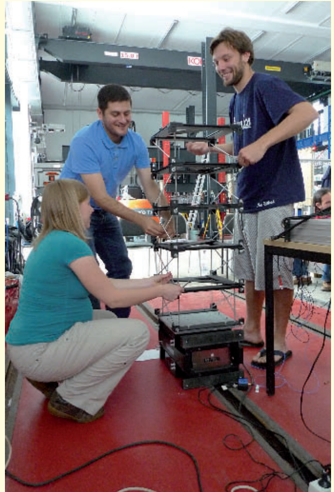
Studierende erproben verschiedene Aussteifungssysteme in Modellversuchen mit Erdbebenanregung.
