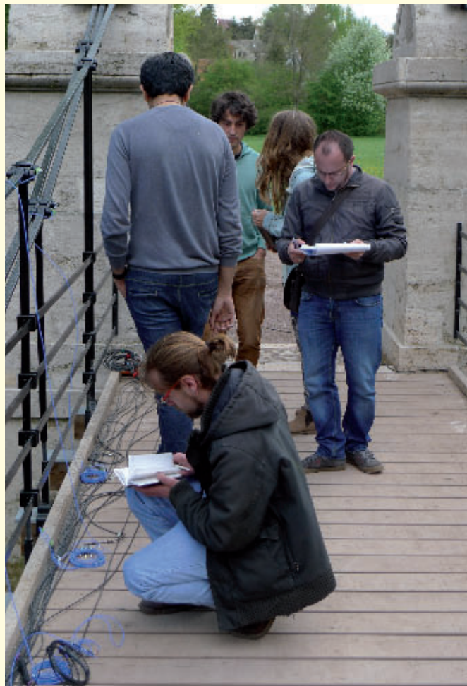
Studierende führen Schwingungsversuche an einer historischen Fußgängerbrücke durch.
