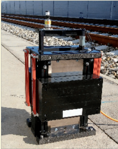
Bild 1. Kraftherregte Schwingungsanregung mit dem tragbaren Long Stroke Shaker
