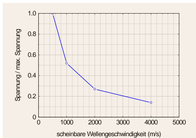
Bild 5. Maximale Spannung (normiert) in der geraden Rohrleitung für verschiedene scheinbare Wellengeschwindigkeiten Grafik: T. Schmitt, L. Reimers
