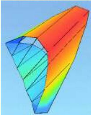
Bild 8a. Form der Grundschiwingung der Brücke.  $f = 0,85 \text{ Hz}$ ,  $\zeta = 0,83 \%$ .
